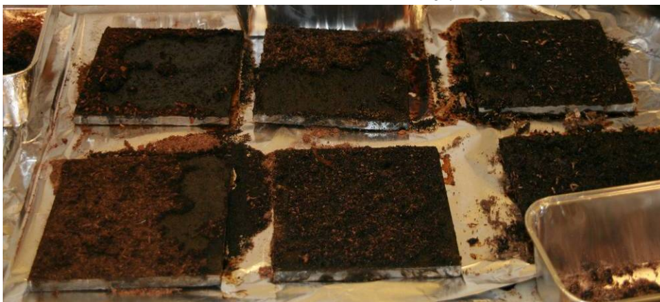
Figur 5; Steinplater med olje og absorbent ved ulike virketid. Absorbentene er hhv øverst fra venstre mot høyre; Barkprodukt – Kallak torv tørket - Kallak torv/spon tørket – Torvprodukt – Kallak torv fuktig – Kallak Torv/spon fuktet
