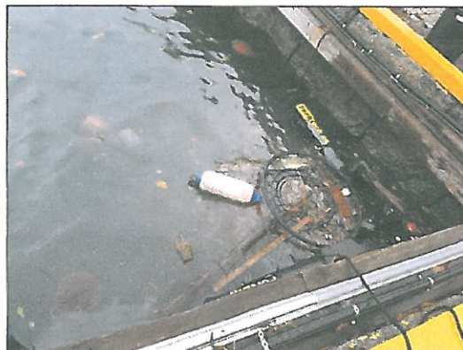
SUGES INN: Prinsippet med Portbin er en sugepumpe som drar vannstrømmen inn, for så å blåse den ut igjen fem meter lenger bort. Søppelet blir igjen i beholderen mens vannet går ut igjen.
